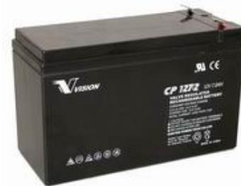
Перезаряжаемые батареи с парой свинец-диоксид свинца. Электролит в виде раствора серной кислоты нейтрализуется при взаимодействии с сепараторами и пластинами. Излишки выработанного водорода и кислорода удаляются через специальные однонаправленные клапаны во избежание чрезмерного роста давления. С другой стороны, аккумуляторная батарея полностью герметична, не требует обслуживания, не допускает утечек и может эксплуатироваться в любом положении.
